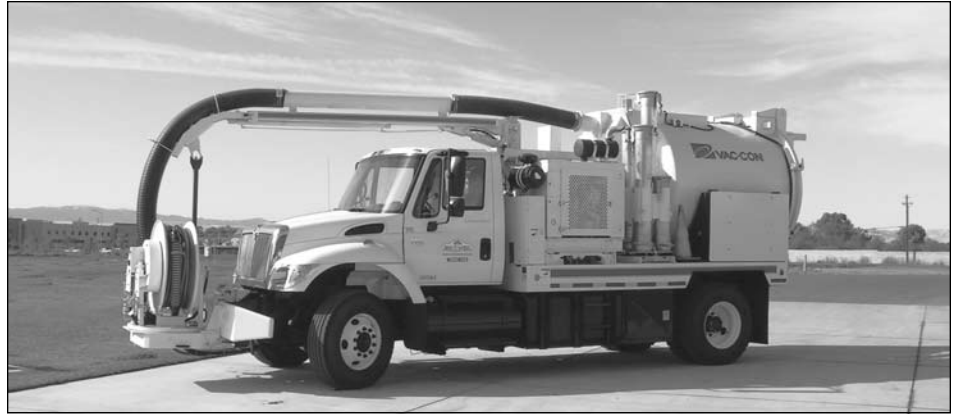
Nueva troca Vac-Con es pieza clave del equipo para el mantenimiento de drenaje y líneas de tormenta.
